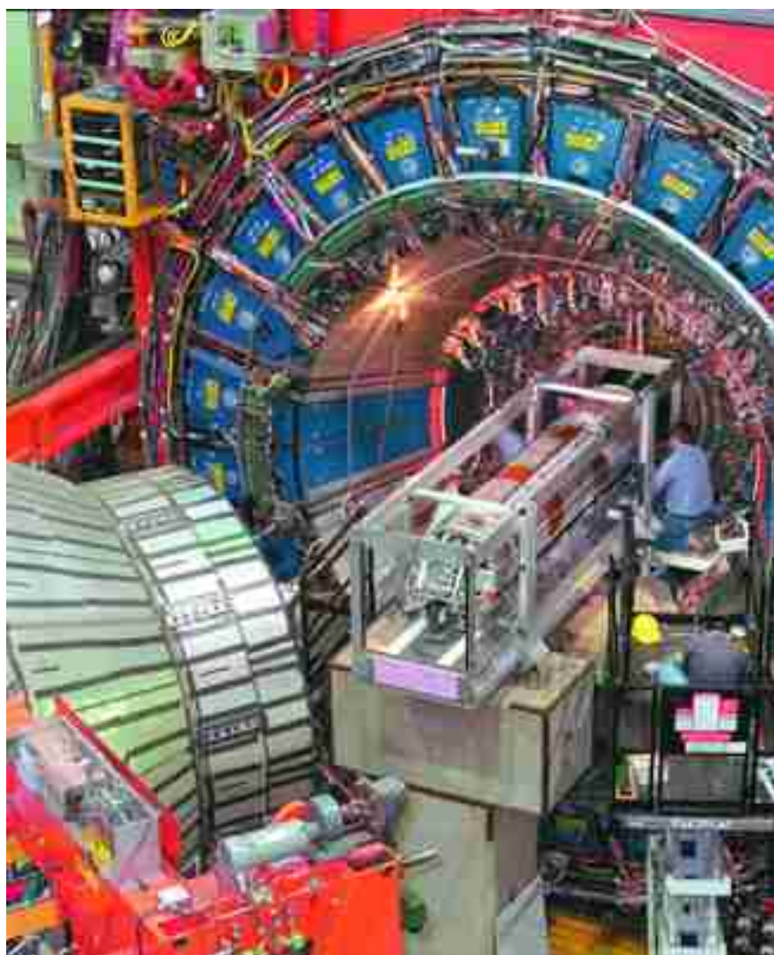
Огромные детекторы частиц на «Теватроне», модернизация которых была проведена физиками лаборатории им. Ферми с 1996 по 2000 гг., используются для наблюдения бозонов Хиггса и суперсимметрии.
